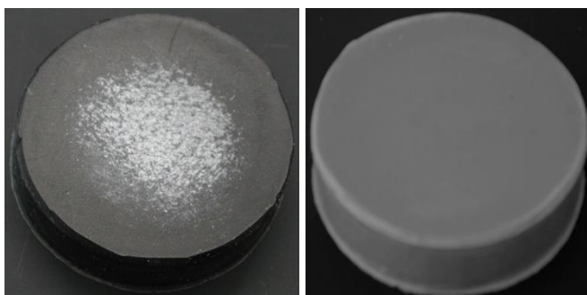
ohne Füllstoff getempert 4 h @ 200°C
