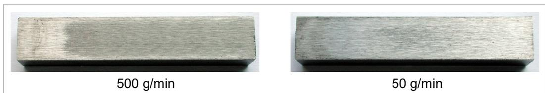
**Abbildung 5:** Einfluss des Durchsatzes auf den Plating-Effekt
