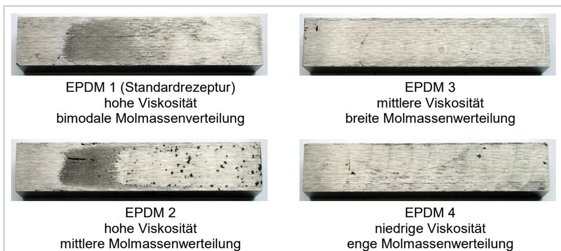
**Abbildung 8:** Messplättchen der Mischungen mit vier verschiedenen Kautschuktypen
